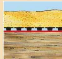
Reitplatzmatte Unterliegmatte ersetzt die mineralische Tragschicht
