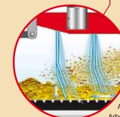
Die Striegelzinken „rühren“ regelrecht im Boden. So durchmischen und lockern sie die Tretschicht (Trennschicht und Unterbau bleiben unberührt).
